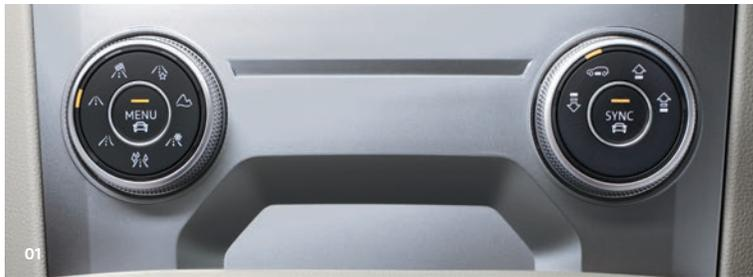
**01** Mit dem **Fahrerlebnis-Schalter** in der Mittelkonsole des neuen Touareg sind Sie auf fast jedes Terrain eingestellt. Über die serienmässig anwählbaren Profile „Normal“, „Sport“, „Comfort“, „Eco“, „Snow“, „Offroad“ und „Individual“, lassen sich Motor und Getriebe sowie das Verhalten bestimmter Assistenzsysteme den Gegebenheiten anpassen. Mit dem optionalen Offroad-Paket sogar noch an zwei weitere: „Schotter“ und „Sand“. **S**
