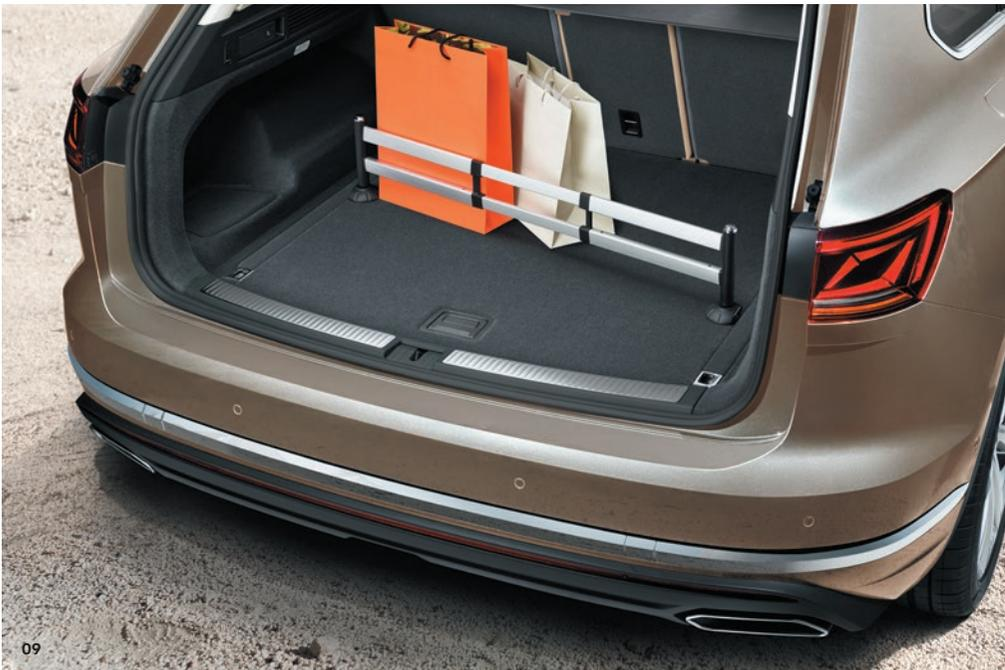
**08** Weiches, schonendes Velours auf der einen und robuste, rutschfeste Kunststoffnoppen auf der anderen Seite: Die passgenaue **Gepäckraumwendematte** bietet für jedes empfindliche, schmutzige oder feuchte Transportgut die richtige Oberfläche. Ein integriertes, herausklappbares **Schutz Tuch** schützt die Ladekante beim Ein- und Ausladen. **SO**
