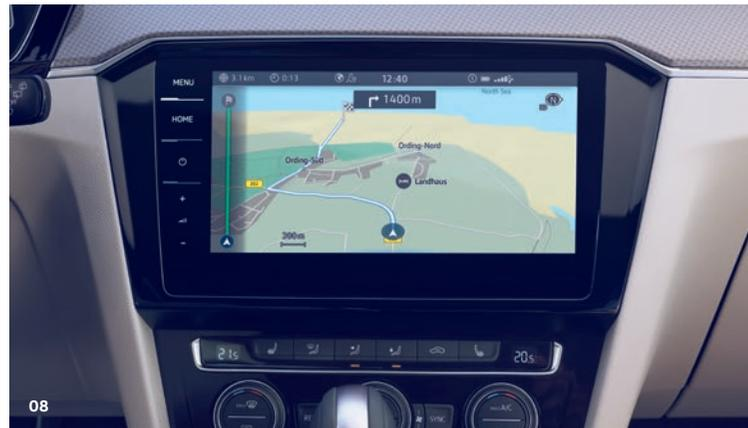
**08** Das Navigationssystem „Discover Pro“ mit mobilen Online-Diensten von We Connect\* lässt sich mit seinem 23,4 cm (9,2 Zoll) grossen, glasüberbauten TFT-Touchscreen mit Farbdisplay, Gestensteuerung und natürlicher Sprachbedienung intuitiv und komfortabel bedienen. Das System verfügt ausserdem über eine Verkehrszeichenerkennung sowie über App-Connect Wireless (für Apple CarPlay™). Acht Lautsprecher sorgen nicht nur beim digitalen Radioempfang über DAB+ für ein optimales Klangerlebnis. **SO**
