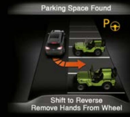
Der optionale Parkassistent für paralleles und rechtwinkliges Einparken wird in der Mitte des Kombiinstrumentes angezeigt. Das System erkennt freie Parklücken, lenkt das Fahrzeug per Knopfdruck und fordert dabei den Fahrer zum Gangwechsel und zur Betätigung von Bremse und Gaspedal auf.
