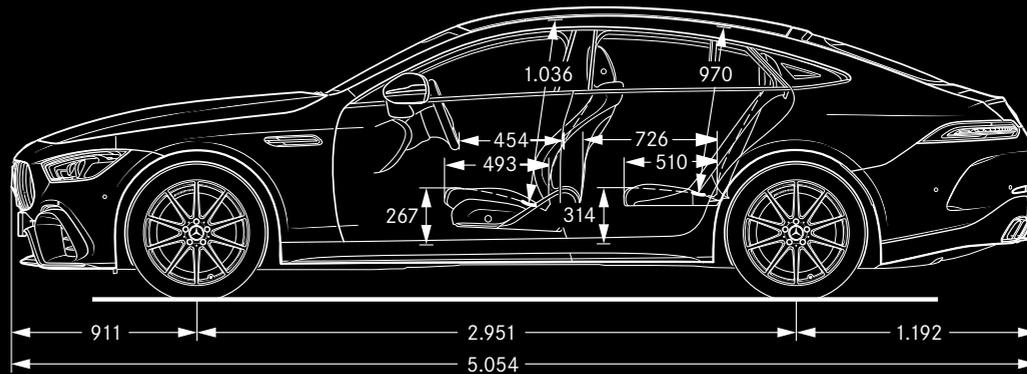
Alle Angaben in Millimetern. Die abgebildeten Masse sind Mittelwerte. Sie gelten für Fahrzeuge in Grundausstattung und in unbelastetem Zustand.
