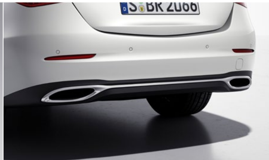
Mittig positionierter Stossfänger in Fahrzeugfarbe mit Einleger (Flügel) in Hochglanzchrom
