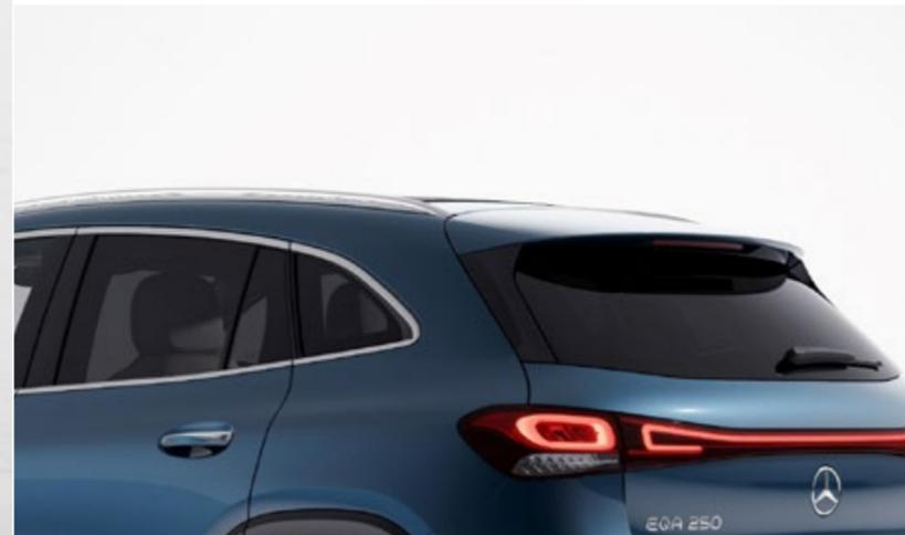
840 – Getönte Wärmeschutzverglasung
