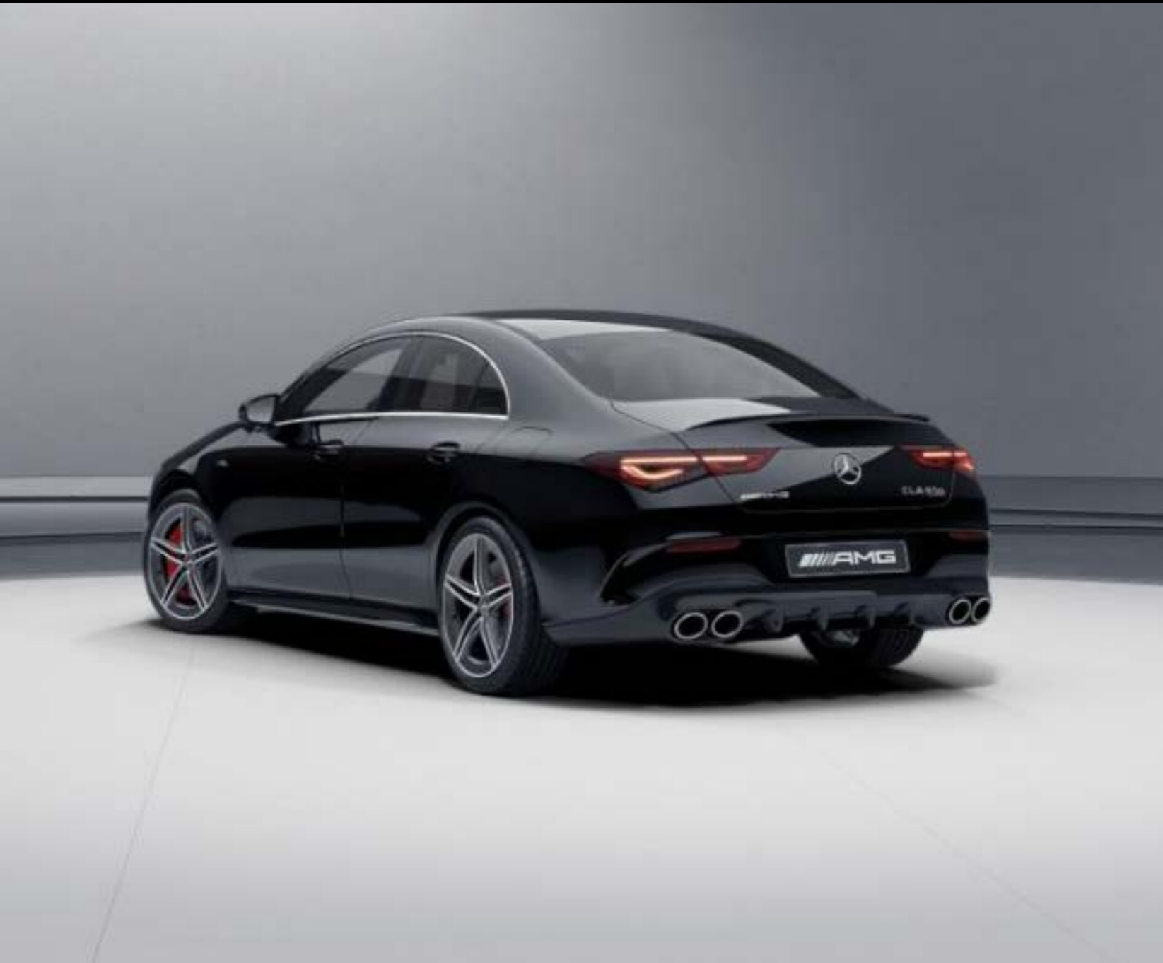
Das Mercedes-AMG CLA 45 S 4MATIC+ Coupé besitzt eine AMG Abgasanlage mit zwei runden Doppelendrohrblenden mit je 90 mm Durchmesser.*
