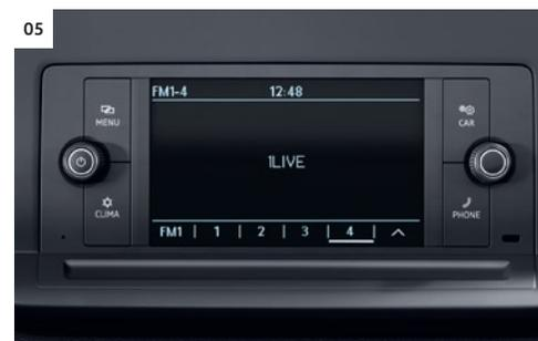
**05 Radiosystem „Composition Audio“.** Das System mit 16,5 cm (6,5 Zoll) grossem Farb-Touchdisplay und bis zu sechs Lautsprechern bietet eine integrierte USB-C- und eine Bluetooth-Telefon-Schnittstelle.
