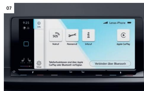
**07 Radiosystem „Ready 2 Discover“.** Zusätzlich zu den Funktionen des Radiosystems „Composition“ bietet das System ein 25,4 cm (10 Zoll) grosses Farb-Touchdisplay und eine Smartphone-Integration. Das System bietet zudem die Möglichkeit, die Navigationsfunktionen nachträglich im In-Car Shop zu erwerben und freizuschalten.
