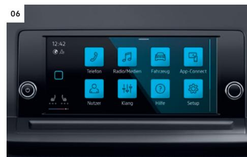
**06 Radiosystem „Composition“.** Zusätzlich zu den Funktionen des Radiosystems „Composition Audio“ bietet das System ein 20,9 cm (8,25 Zoll) grosses Farb-Touchdisplay, sechs Lautsprecher, zwei USB-C-Schnittstellen in der Mittelkonsole und eine Bluetooth-Schnittstelle. Das System unterstützt WeConnect<sup>6)</sup> und We Connect Plus<sup>5), 6)</sup>.
