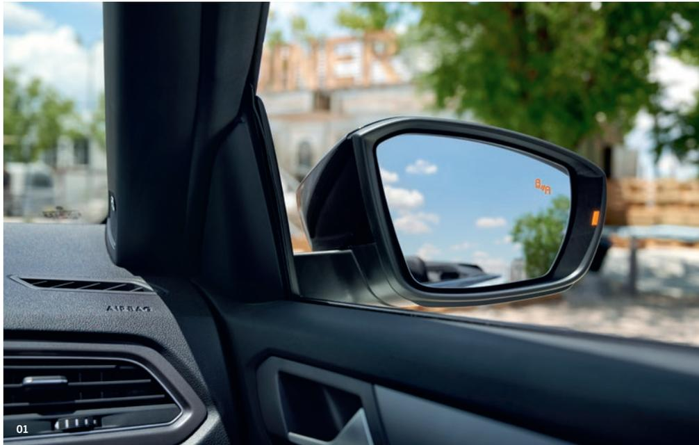
**01** Während der Fahrt kann Sie der „Blind Spot“-Sensor über LEDs im jeweiligen Aussenspiegel vor Fahrzeugen im toten Winkel warnen.<sup>1</sup> Beim Rückwärtsausparken kann der integrierte Ausparkassistent den Bereich hinter Ihrem Fahrzeug überwachen und Sie so vor erkanntem querendem Verkehr warnen.<sup>1</sup> **SO**
