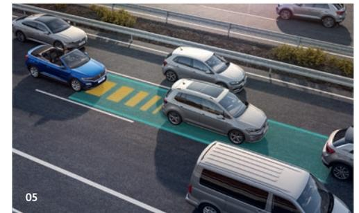
**05** Der optionale Staussistent kann im Stop-and-go-Verkehr dank ACC und Spurhalteassistent selbstständig dem vorausfahrenden Fahrzeug folgen und dabei die Spur halten.<sup>1,3</sup> Das verwandelt Frust in Entspannung. **SO**
