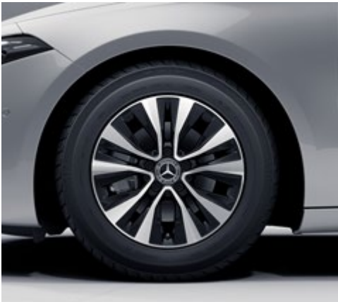
43R – 16"-Leichtmetallräder im Vielspeichen-Design, aerodynamisch optimiert, serienmässig bei SE (PYB) mit 205/60 R 16 auf 6,5 J × 16
