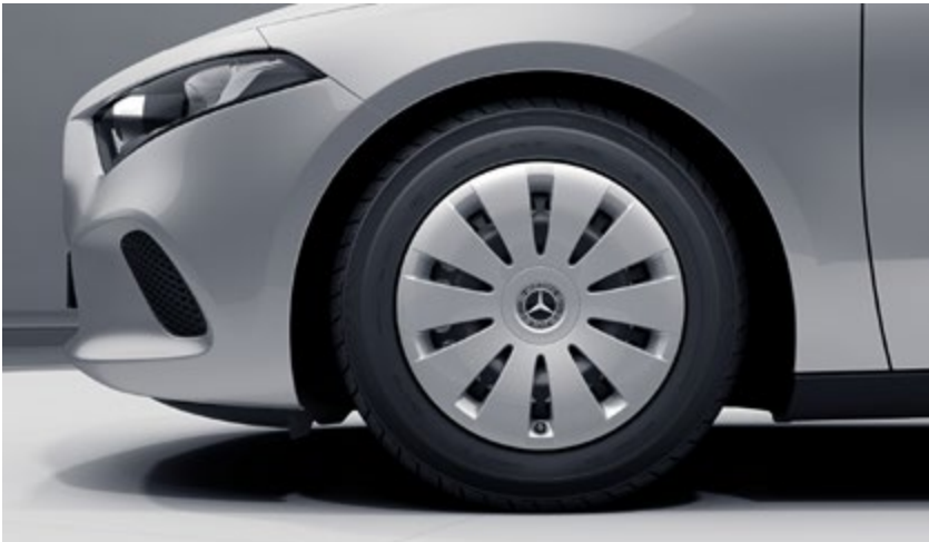
R00 – 16"-Stahlräder mit Radabdeckungen im 10-Loch-Design, serienmässig mit 205/60 R 16 auf 6,5 J × 16
