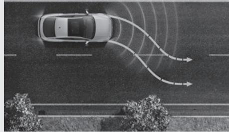
Seien Sie im Notfall vorbereitet – mit dem Assistenzsystem „Emergency Assist“, das einen Teil der Fahrzeugsteuerung im medizinischen Notfall übernimmt. Es wird aktiv, wenn keine Aktivität des Fahrers mehr registriert wird. Findet keine Übernahme der Steuerung statt, wird das Fahrzeug mithilfe des Spurwechselassistenten „Side Assist“ bis auf die rechte Fahrspur geleitet und kontrolliert zum Stillstand gebracht. Ein Unfall kann so im Rahmen der Systemgrenzen verhindert werden.
